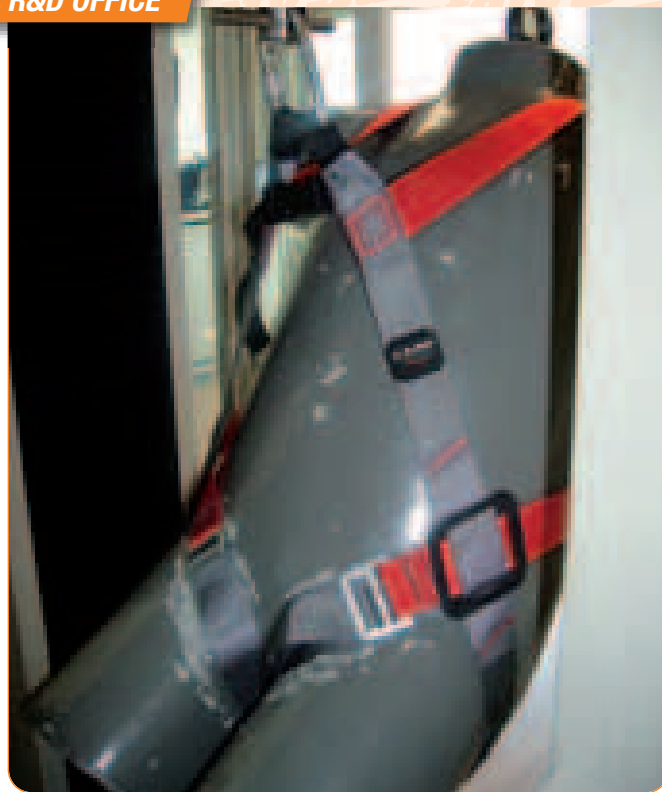
Prova di trazione della nuova imbracatura "Basic Duo". Tensile test of the new "Basic Duo" harness.
