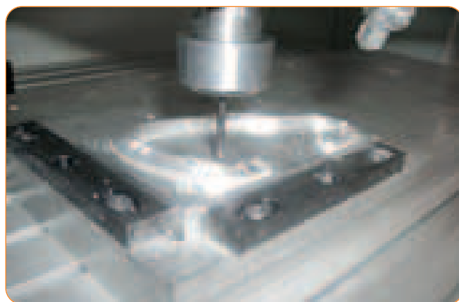
Prototipazione rapida di un connettore in lega d'alluminio tramite fresatrice CNC. CNC milling of a connector made from aluminium alloy.
