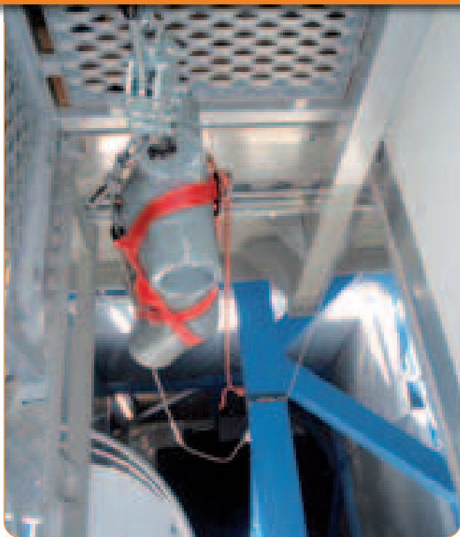
Prova di caduta di un prototipo di imbracatura. Drop test of a new harness prototype.
